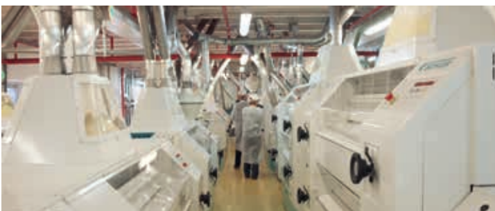
Besichtigung einer modernen Mühle (Walzenstuhlboden)
